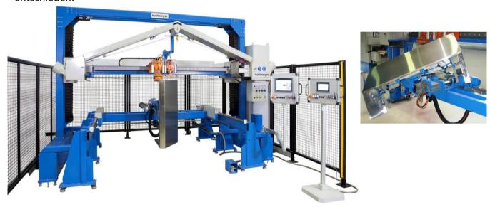
Mit der vollautomatisierten Lösung kann der Hersteller die Bearbeitungszeiten für große Dunstabzugshauben aus Edelstahl um den Faktor 2,5 reduzieren. Darüber hinaus können die Bediener in den automatisierten Bearbeitungszeiträumen weitere Vorarbeiten erledigen, sodass bis zu 3 mal so viele fertige Teile, im Vergleich zur manuellen Bearbeitung, produziert werden können. Es wird eine nahezu ausschussfreie Qualität durch die wiederholgenauen Programmabläufe erreicht.
